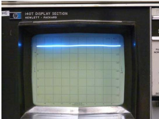
Niveau sur la sortie réfléchi entre 1200 et 1300MHz sans charge fictive connectée sur la sortie N
